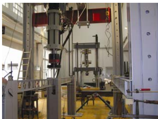
Slika 12. Univerzalni stroj za statičko-dinamička ispitivanja kapaciteta 600 kN
