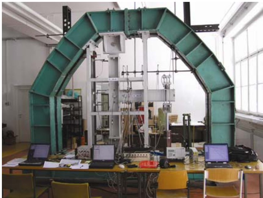
Slika 7. Ispitivanje čeličnog spoja greda-stup
