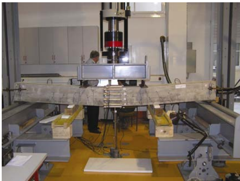
Slika 8. Ispitivanje predgotovljenih armiranobetonskih nosača
